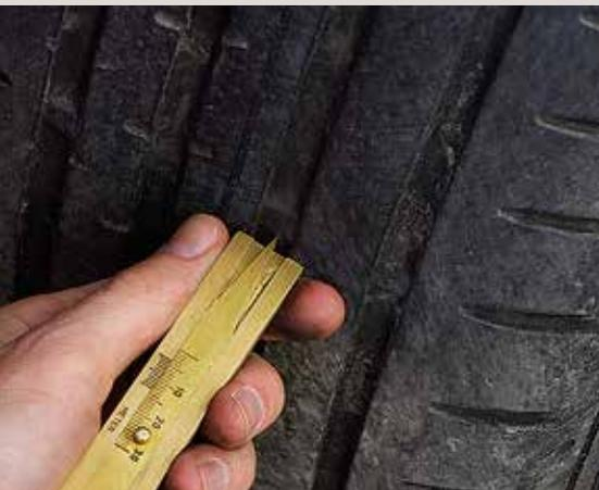
Leichte Materialabtragung an der Scheuerleiste
