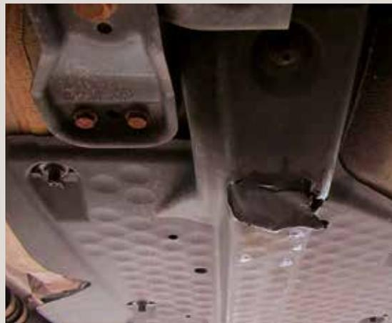
Beschädigung der Unterbodenverkleidung
